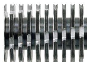
Die induktionsgehärteten Vollstahl-Schneidwellen garantieren Langlebigkeit.
