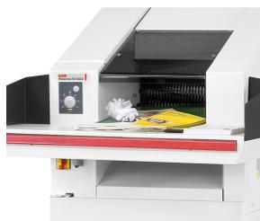
Eine integrierte Lichtschranke startet das Gerät automatisch und stoppt selbstständig nach dem Schreddern.
